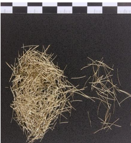
Abbildung 2: Beispiel für verwendbare Stahlfasern mit 13 mm Länge und 0,2 mm Dicke (Foto: MKP GmbH 2023)
