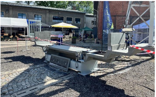
Abbildungen 32, 33, 34: oben links: Betonage im Fertigteilwerk, der spätere Schottertrug ist dabei senkrecht aufgestellt. Oben rechts und unten links: Detail der Anschlussfuge, die mit UHFV vergossen wird. Unten rechts: Ausstellung des Musterbauteils bei den Chemnitzer Eisenbahntagen 2024 (Fotos: oben links: M. Großkopff, oben und unten rechts: M. Falk, unten links: C. Pelka, 2024).
